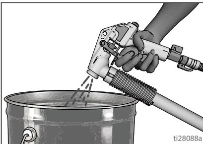
3. Retirez l'embout du pistolet. Actionner le pistolet en le tenant dans un seau jusqu'à ce que la plus grande partie du mélange soit hors de la trémie. Laissez l'eau circuler dans le pistolet jusqu'à ce qu'il soit propre.
